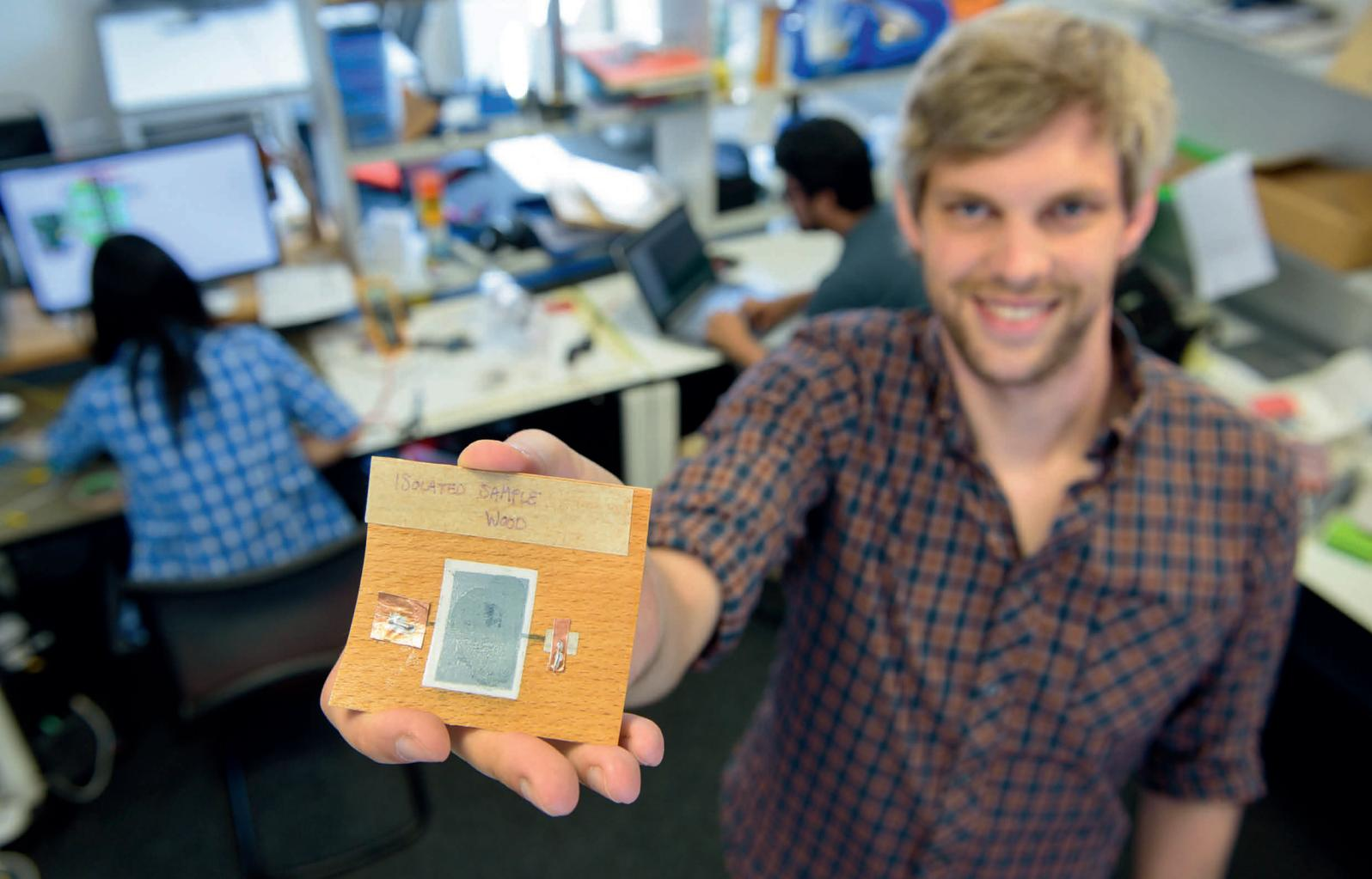
Prototypen: Doktorand Simon Olberding zeigt ein dünnes, lichtemittierendes Display, das die Wissenschaftler mit dem PrintScreen-Verfahren auf Holz gedruckt haben. Das Display erfasst Toucheingaben des Nutzers durch das Furnier hindurch. Ebenfalls mit dieser Methode wurde das Display gedruckt, das eine herkömmliche Swatch-Armbanduhr ergänzt und mehrere Symbole anzeigt – etwa wenn man eine E-Mail-Nachricht erhalten hat.
