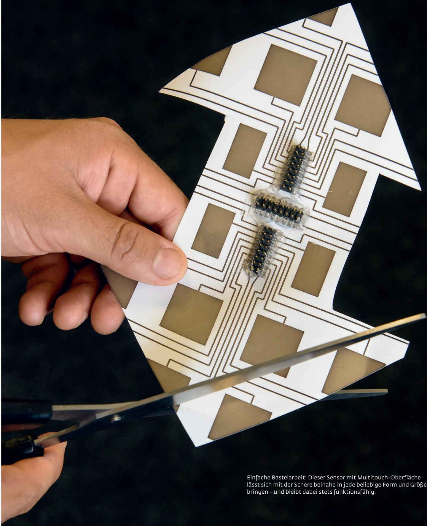
Einfache Bastelarbeit: Dieser Sensor mit Multitouch-Oberfläche lässt sich mit der Schere beinahe in jede beliebige Form und Größe bringen – und bleibt dabei stets funktionsfähig.
