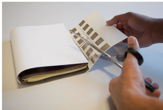
Abb. 5 Zugeschnitten auf die Größe des Buches, kann der Multi-touch-Sensor als interaktives Buchcover verwendet werden
